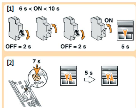
2 - Appuyer sur le bouton «prog» jusqu'à deux brefs mouvement du volet ( 7s )
